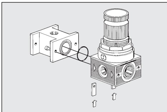
Montaggio presa aria in ingresso: utilizzare solo n. 2 viti e guarnizioni OR fornite nel kit PA.
