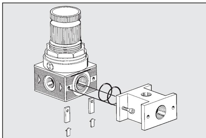
Montaggio presa aria in uscita: utilizzare solo n. 2 viti e guarnizioni OR fornite nel kit PA; la tenuta è assicurata dal contatto OR-OR.
